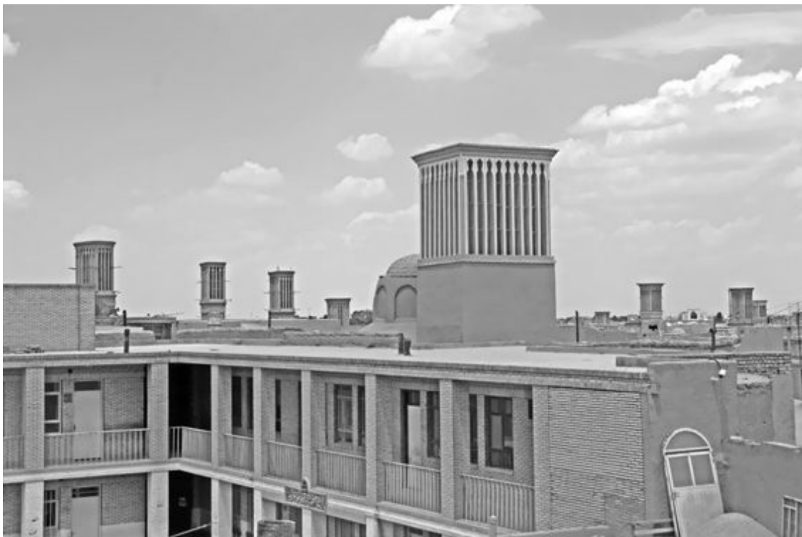
Vista de uma torre de vento, em Yazd, região central do Irã, usada para refrescar as casas na Antiguidade. Essa tecnologia é tida como antecessora do ar-condicionado moderno.
